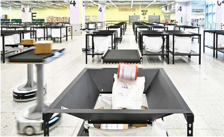
分揀機械人按系統記錄的資料，把郵包運送到所屬卸貨架的郵袋裏。
